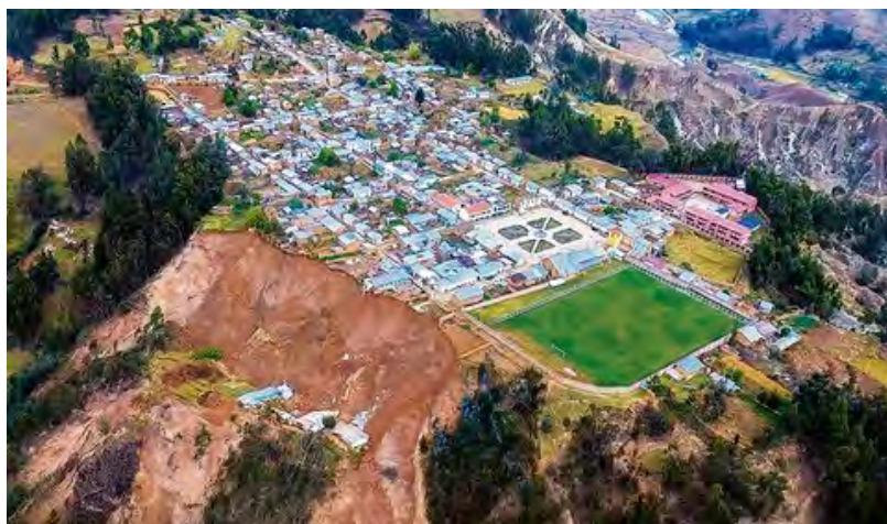
DESLIZAMIENTO DE MASAS
